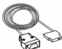
این کابل که در جلوی مازول ( همان محل قرارگیری کارت حافظه ) نصب میگردد برای انتقال اطلاعات از کامپیوتر (PC) به ZEN و بلعکس مورد استفاده قرار میگیرد.
